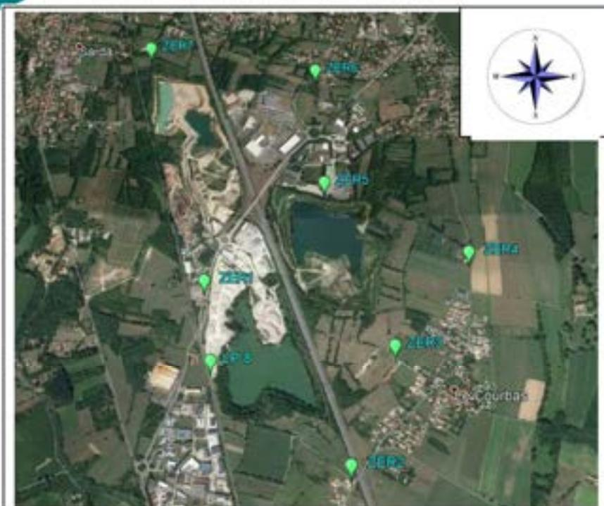
Les mesures sont effectuées en limite de site (Lp) et au droit des zones à émergences réglementées (ZER).
